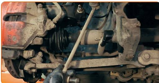
Výměna: tyčky stabilizátoru - VW Passat Variant (365). Tip od odborníků z AUTODOC:
