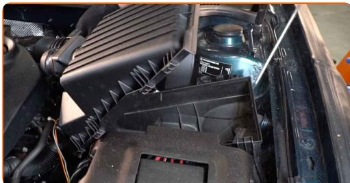
**Výměna: vzduchového filtru - VW PASSAT Variant (3A5, 35I). Profesionálové doporučují:**
