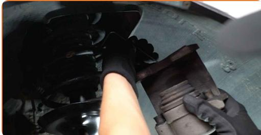
Výměna: brzdové destičky - VW PASSAT Variant (3A5, 35I). Profesionálové doporučují:
