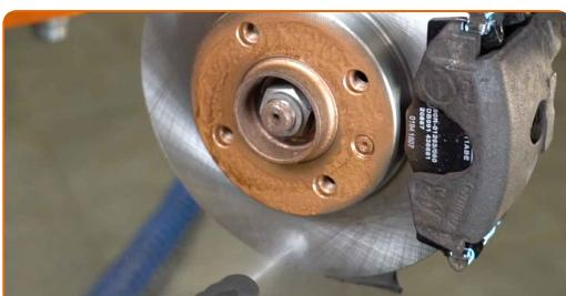
Výměna: brzdové destičky - VW PASSAT Variant (3A5, 35I). Doporučují odborníci z AUTODOC:
