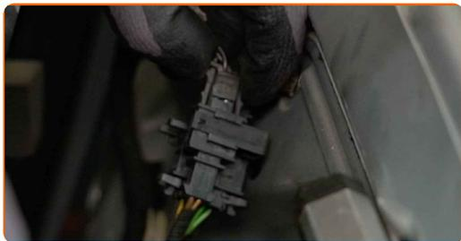
**8** Odstraňte kryty z upevňovacích prvků zdvihačů oken. Použijte plastový nástroj na demontáž čalounění.
