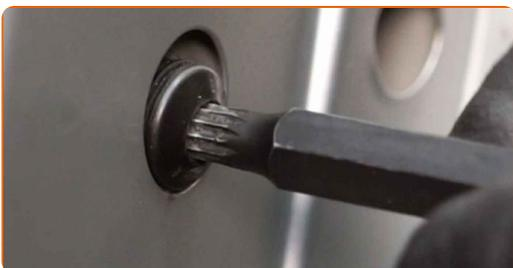
**52** Utáhněte upevňovací prvky zámku dveří. Použijte XZN č. 8. Použijte momentový klíč. Utáhněte ji točivým momentem 20 Nm.
