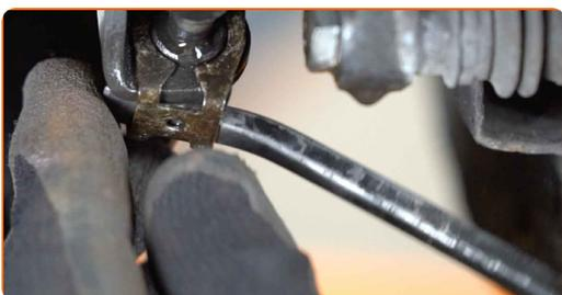
**9** Odpojte lanko ruční brzdy od třmenu. Použijte kleště na vodní pumpu. Uvolněte lanko parkovací brzdy.
