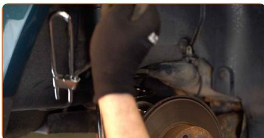
**23** Odpojte odvzdušňovací šroub brzdového třmenu.
