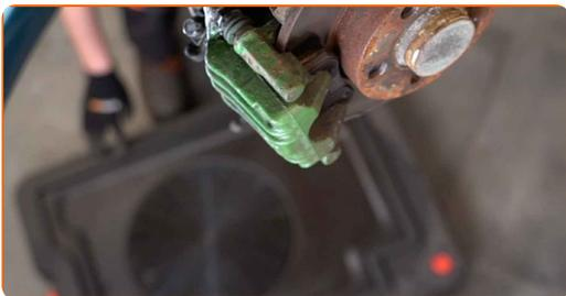
**12** Odšroubujte prvky brzdové hadičky od brzdového třmenu. Použijte nástavec č.13. Použijte ráčnový klíč.
