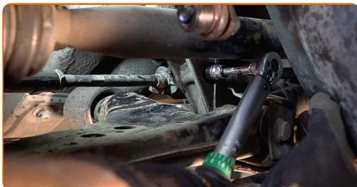
Výměna: silentbloku stabilizátoru - VW POLO (9N\_). AUTODOC doporučuje:
