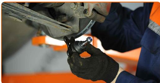
Výměna: kulový čep ramene - VW Polo Hatchback (6N1). AUTODOC doporučuje:
