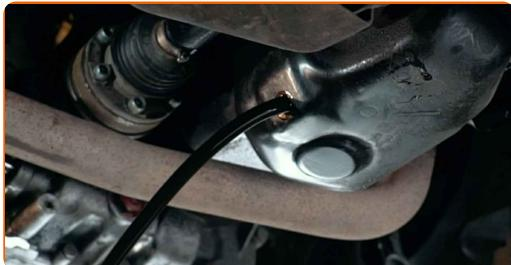
Výměna: motorového oleje a filtru - VW Polo Hatchback (6R1, 6C1). AUTODOC doporučuje:
