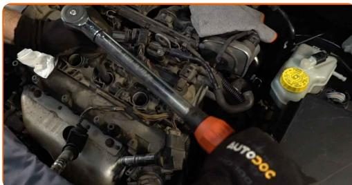
Výměna: zapalovacích svíček - VW Polo Hatchback (6R1, 6C1). AUTODOC doporučuje:
