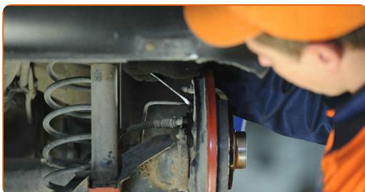
Výměna: brzdového válečku - VW Polo Hatchback (86C, 80). Tip od AUTODOC:
