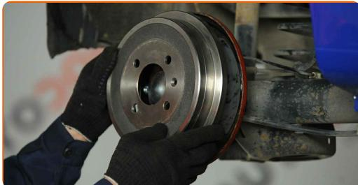
Výměna: brzdového válečku - VW Polo Hatchback (86C, 80). Tip od odborníků z AUTODOC:
