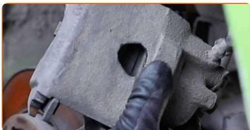
Výměna: brzdové destičky - VW Polo III Hatchback (6N2). Profesionálové doporučují:
