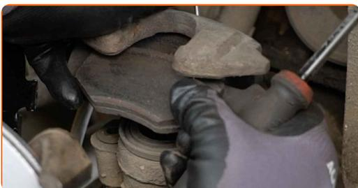
Výměna: brzdové destičky - VW Polo III Hatchback (6N2). Doporučují odborníci z AUTODOC:
