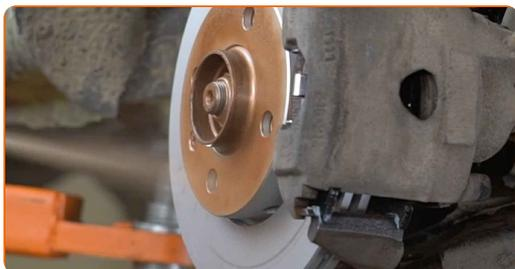
22 Vyčistěte povrch brzdového kotouče. Použijte čistič brzd.
