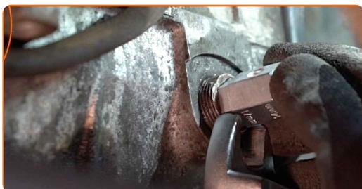
**15** Vyčistěte prostor okolo plnicího otvoru krytu převodové skříně. Použijte víceúčelový čisticí sprej.
