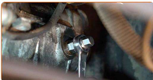
**11** Zašroubujte novou zátku výpustného otvoru a utáhněte ji. Použijte imbusový klíč č. H17. Použijte momentový klíč. Utáhněte ji točivým momentem 29 Nm.
