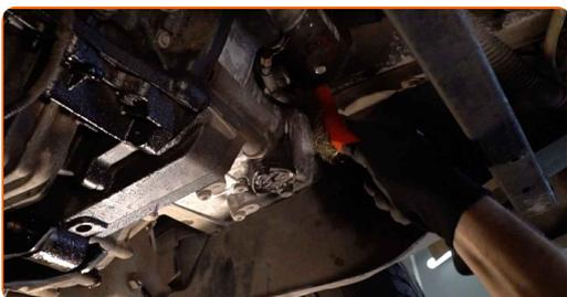
**6.2** Vyčistěte místo výpustného otvoru olejové vany. Použijte drátěný kartáč. Použijte sprej WD-40.
