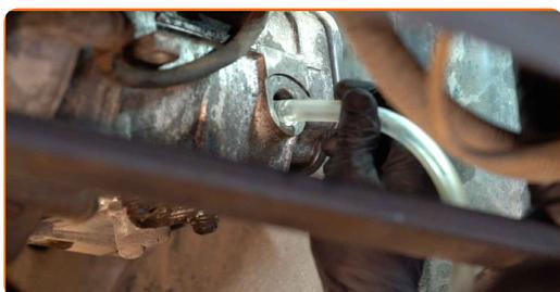
**13** Nalijte olej do převodové skříně přes plnicí otvor.
