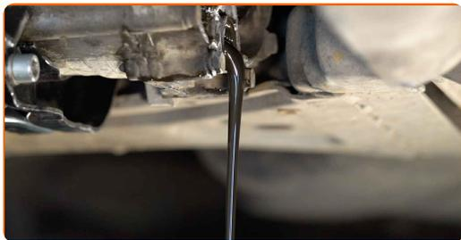
Výměna: olej do manuální převodovky - VW Polo III Variant (6V5).
