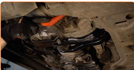
**7** Pod výpustný otvor položte nádobu na vytékající olej o objemu alespoň 3 l.
