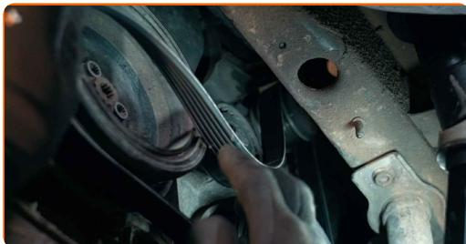
**Výměna: drážkového řemene - VW Polo III Variant (6V5). Tip:**
