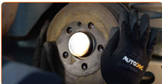
**18** Utáhněte upeňovací prvky brzdového bubnu. Použijte křížový šroubovák PH. Použijte momentový klíč. Utáhněte ji točivým momentem 4 Nm.
