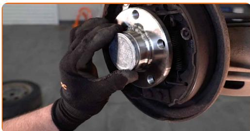
**16** Natřete náboj v místě kontaktu s brzdovým kotoučem. Použijte měděné mazivo.
