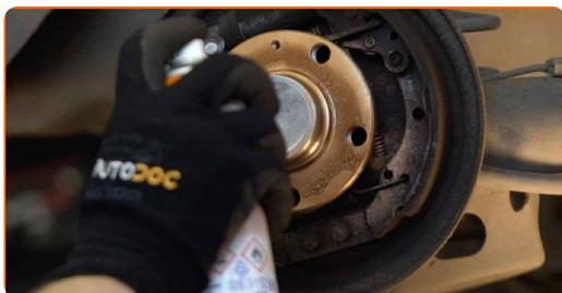
**17** Nainstalujte brzdový buben a upevněte jej.
