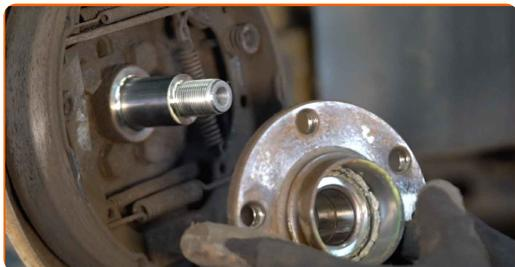
12 Vyčistěte montážní otvor ložiska náboje. Použijte víceúčelový čisticí sprej.
