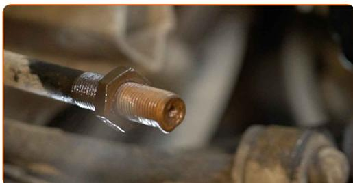
**14** Zašroubujte novou koncovku táhla řízení. Použijte posuvné měřidlo.
