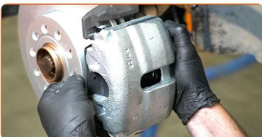
**19** Nainstalujte krytky prachového pouzdra vodičích závlaček brzdového třmenu.
