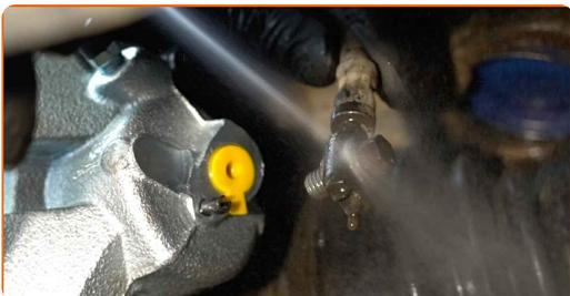
Výměna: brzdového třmenu - VW POLO VIVO Sikma zadní část. Tip:
