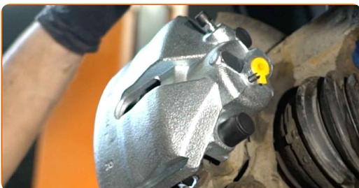
**20** Nainstalujte držící pružinu brzdových destiček.
