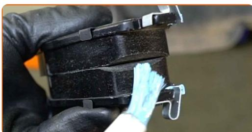
**Výměna: brzdové destičky - VW T-Roc (A11). Doporučují odborníci z AUTODOC:**
