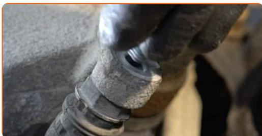
**20** Utáhněte upevňovací prvky brzdového třmenu. Použijte nástavec č.13. Použijte momentový klíč. Utáhněte ji točivým momentem 35 Nm.
