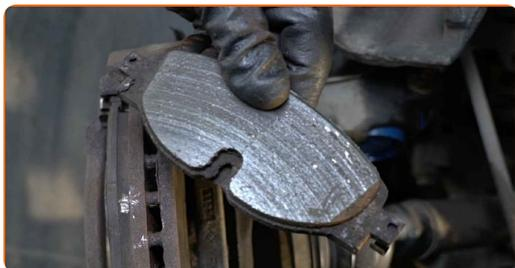
Výměna: brzdové destičky - VW T-Roc (A11). Tip od AUTODOC:
