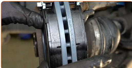
**18** Nainstalujte brzdový třmen a upevněte jej.
