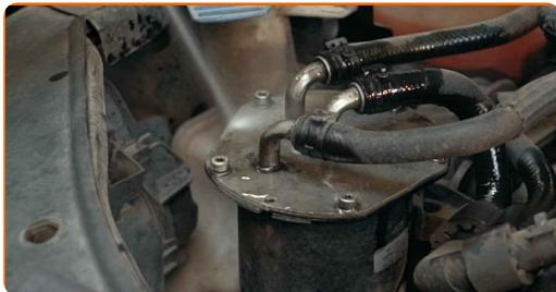
**4** Odšroubujte upevňovací prvky krytu uložení palivového filtru. Použijte hvězdicový Torx T15. Použijte ráčnový klíč.
