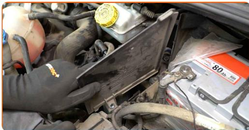
**23** Zašroubujte upevňovací prvky panelu krytu spodní části karoserie. Použijte nástavec č.13. Použijte ráčnový klíč.
