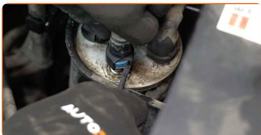
Výměna: palivového filtru - VW Touareg (7LA, 7L6, 7L7). Profesionálně doporučují:
