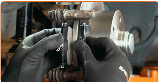
**36** Nainstalujte brzdový třmen a upevněte jej. Použijte kombinační klíč č.15. Použijte nástavec č.13. Použijte momentový klíč. Utáhněte ji točivým momentem 35 Nm.
