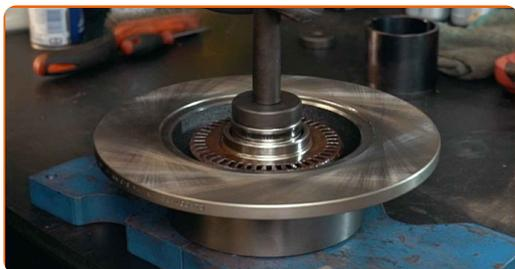
Výměna: ložiska kola - VW TRANSPORTER III autobus. Tip:
