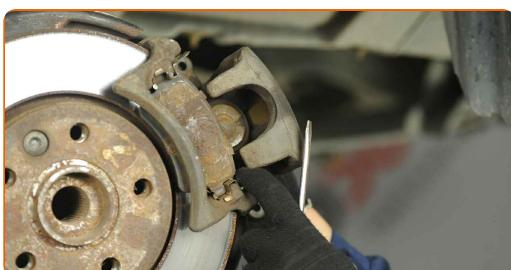
Výměna: brzdového kotouče - VW Transporter VI Mikrobus (SGB, SGG, SGJ).
