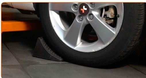
**3** Uvolněte upevňovací šrouby kola. Použijte rázový nástavec na kolo č. 19.
