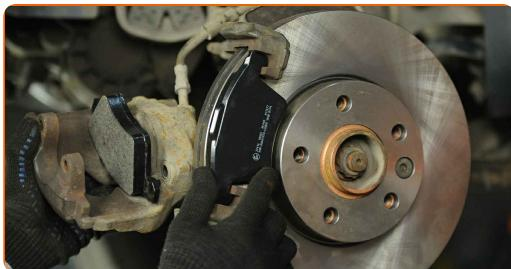
Výměna: brzdové destičky - VW Transporter VI Van (SGA, SGH). Tip od odborníků z AUTODOC:
