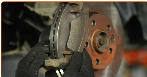
Výměna: brzdové destičky - VW Transporter VI Van (SGA, SGH).
