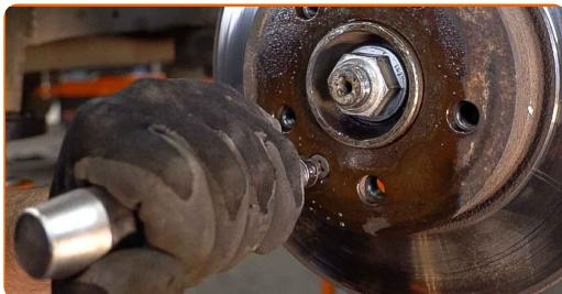
Výměna: brzdového kotouče - Mercedes Vito W638. Tip od odborníků z AUTODOC:
