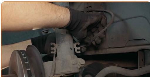
**15** Vyčistěte spodní upevnění spojující tlumič k hlavě ložiska čepu kola. Použijte drátěný kartáč. Použijte sprej WD-40.
