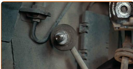
**14** Odpojte vodiče snímače ABS.
