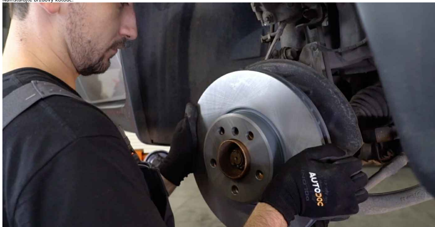
24 Upevněte upevnění brzdového kotouče. Použijte hvězdicový Torx T 30. Použijte momentový klíč. Utáhněte ji točivým momentem 16 Nm.
