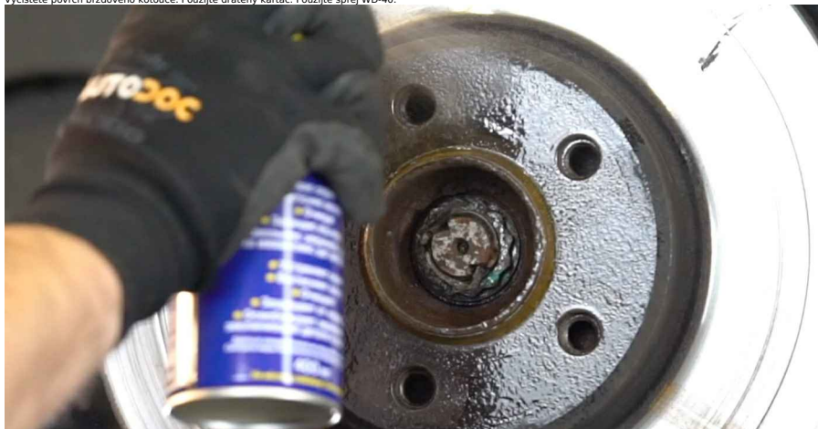
20 Odšroubujte upevnění brzdového kotouče. Použijte hvězdicový Torx T 30. Použijte nárazový šroubovák.
