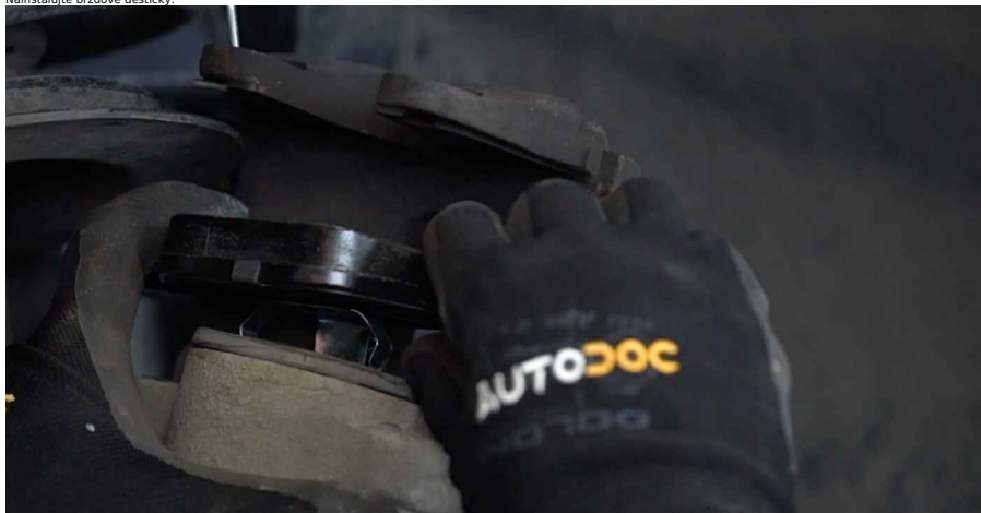
30 Nainstalujete brzdový třmen a upevníte jej. Použijte imbusový klíč č. H7. Použijte momentový klíč. Utáhněte ji točivým momentem 30 Nm.
