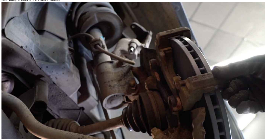
26 Upevněte svorku brzdového třmenu. Použijte nástavec č.16. Použijte momentový klíč. Utáhněte ji točivým momentem 110 Nm.
