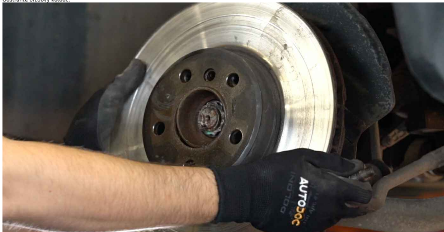
22 Vyčistěte náboj. Použijte drátěný kartáč. Natřete kontaktní povrch. Použijte měděné mazivo.
