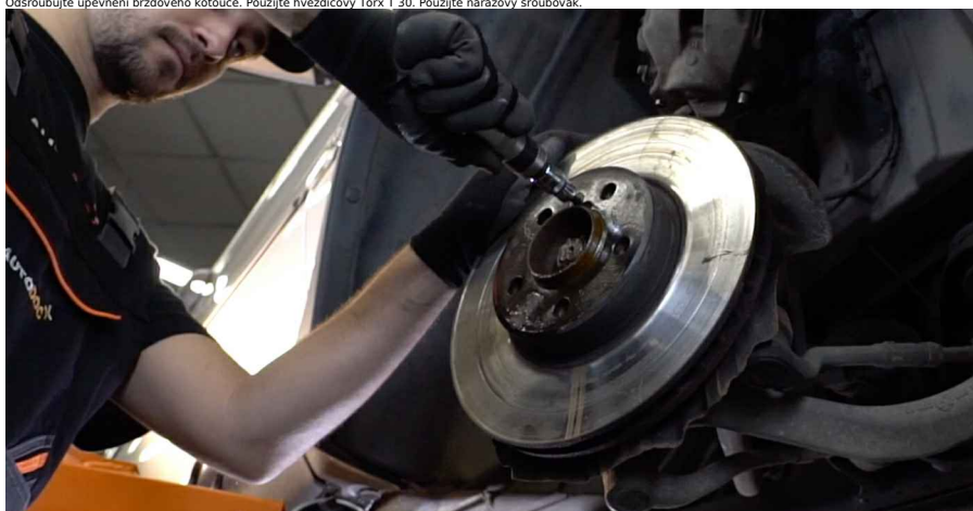
Výměna: brzdového kotouče - BMW X5 E53. Tip: • Pokud je to nutné, použijte gumové kladivo.
