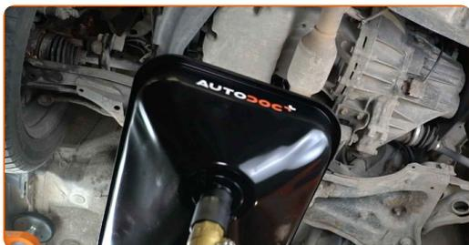
**7** Vyčistěte místo výpustného otvoru olejové vany. Použijte drátěný kartáč. Použijte víceúčelový čisticí sprej.
