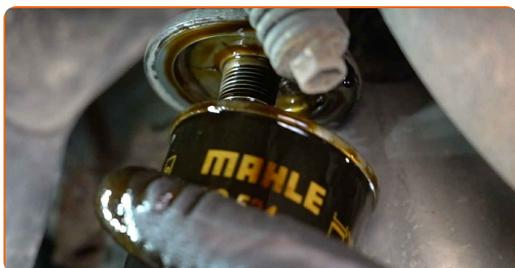
**13** Vyčistěte místo uložení olejového filtru. Použijte víceúčelový čisticí sprej.
