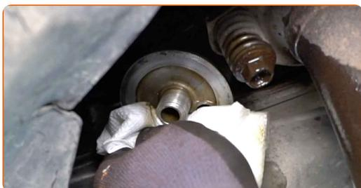
**14** Namažte gumové těsnění nového filtru malým množstvím čerstvého oleje.
