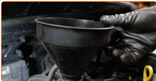
**23** Nalijte olej do motoru přes plnicí hrdlo. Potřebné množství oleje: 3.2 l.
