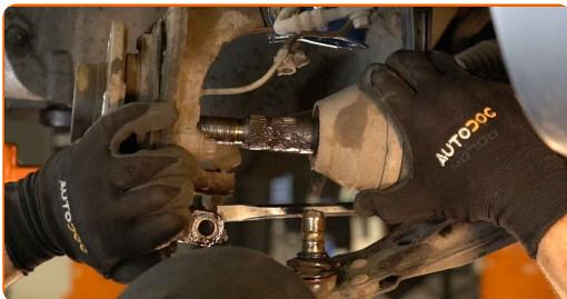
Výměna: ložiska kola - Opel Zafira B A05. Doporučují odborníci z AUTODOC:
